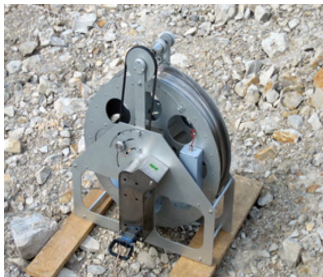
Slika 5. Vitlo s mineralno izoliranim kablom
