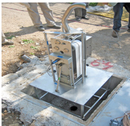
Slika 4. Traktorska jedinica postavljena na aluminijskoj ploči
