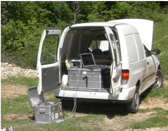
Slika 7. ALADIN kontrolni uređaj i terenski laptop postavljeni na kutiju u VW Caddy-u.
